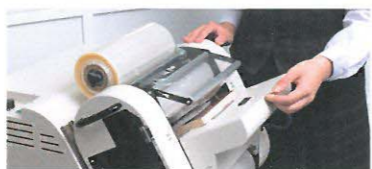
看板商品「コミックシュリンカー」。1時間のうちに1300冊のコミックが自動的に包装される仕組み。書店員の使い勝手を考え、キャスター付きで持ち運びも便利に設計されている。
