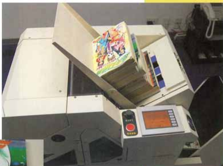
投入スペースに置いておくだけで文庫本からA5判までの書籍を自動的に包装する専用シュリンカー。
