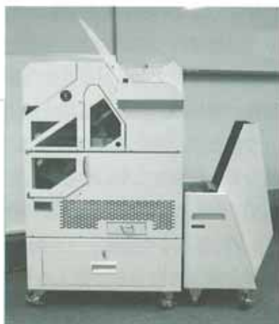
「誰にでも使えるように」と改良が重ねられたシュリンカー。最新機種はRAPO1400は1時間当たり1,400冊の処理能力をもつ
