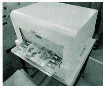
図4●卓上型の「PIKO300S」 300冊/時の処理能力を持つ小型のシュリンカ。
